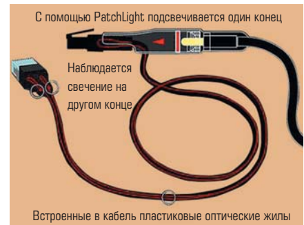
Рис. 3. Схематичная иллюстрация идеи PatchSee, а также ее реализация
