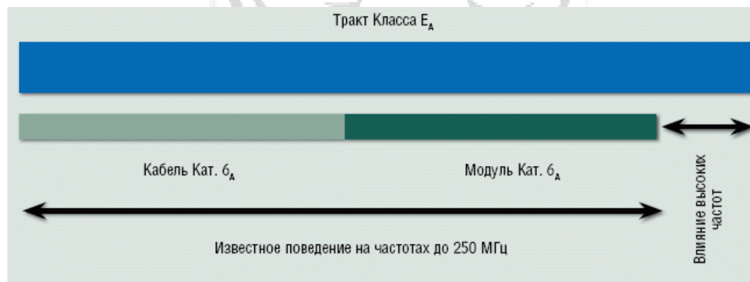
Рисунок 3. Влияние высоких частот — основная проблема компонентов Категории 6 A .
